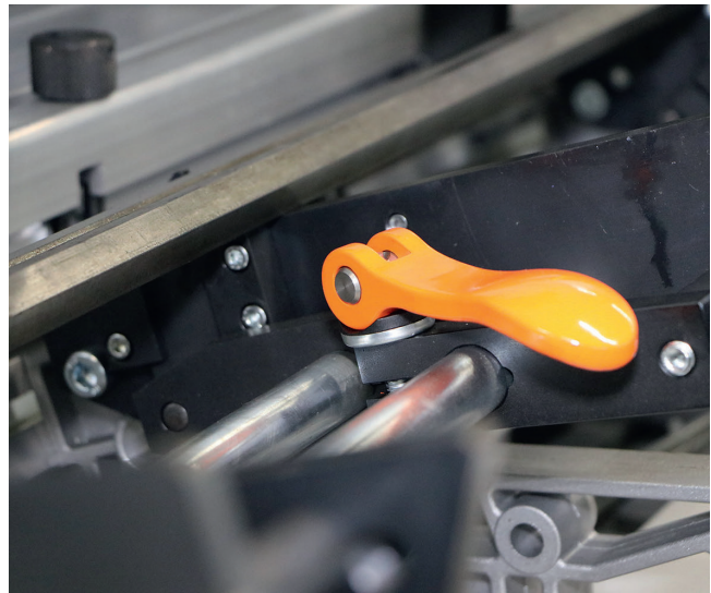
3 Durch die Formgebung und die angepasste Farbe des Exzenterhebels konnte Kipp eine gut sichtbare und ergonomische Klemmstelle für FMB realisieren © Kipp
