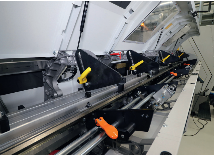
2 Klemmhebel in Rapsgebl und Exzenterhebel in Reinorange unterstützen die einfache und ergonomische Bedienung des Stangenlademagazins © Kipp
